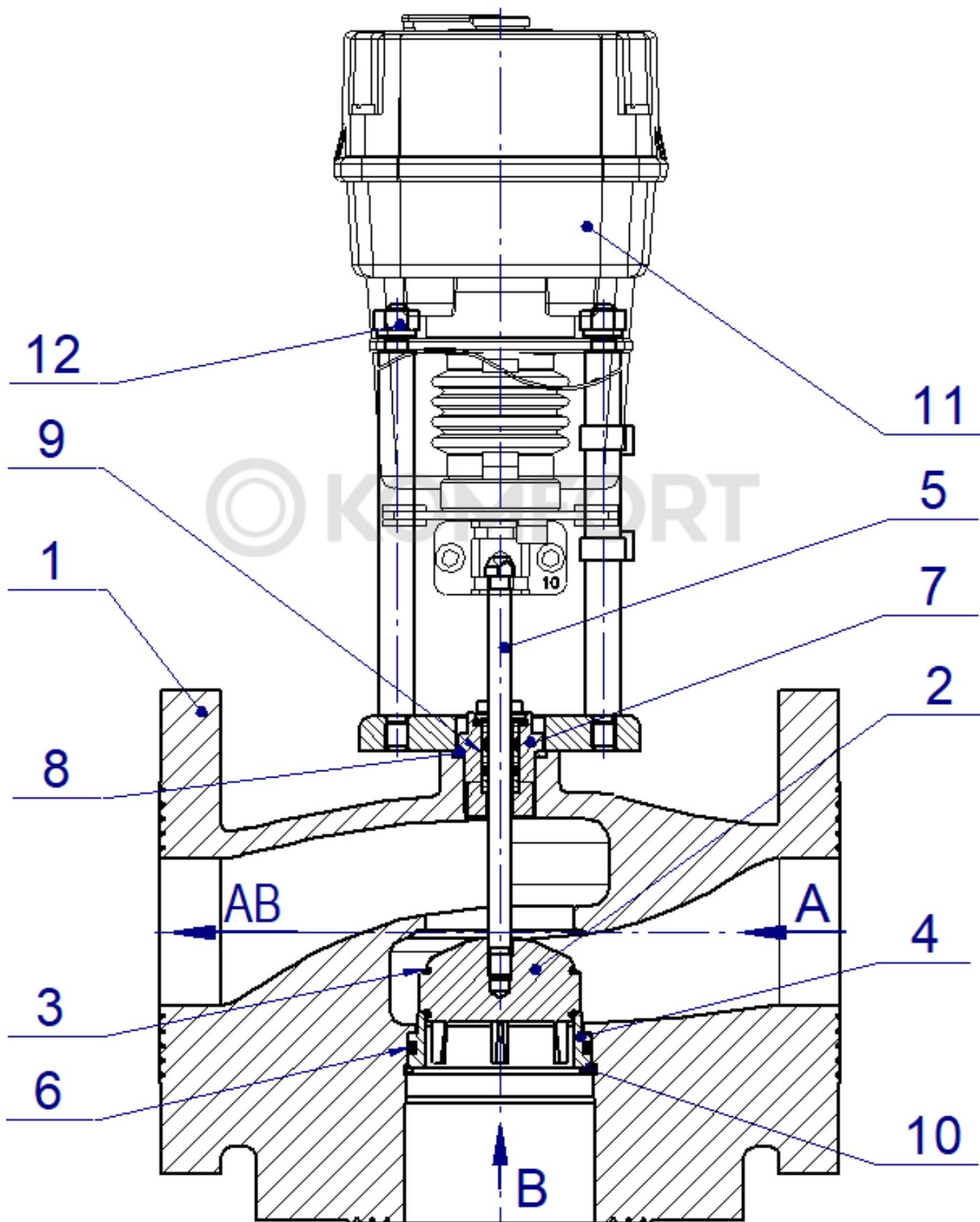
Рисунок А.1 Устройство клапана для DN 15 ÷ DN 50
