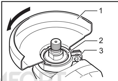
► 1. Кожух диска 2. Узел подшипника 3. Винт
