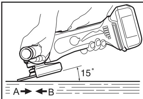
ВСЕГДА крепко держите инструмент одной рукой за корпус, а другой за боковую рукоятку. Включите инструмент и поднесите круг или диск к обрабатываемой детали. В общем край диска необходимо держать под углом примерно в 15 градусов к поверхности обрабатываемой детали.
