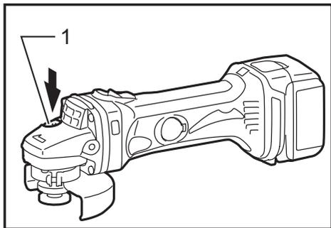
► 1. Фиксатор вала
