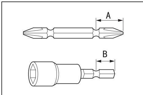
Используйте только насадки для отвертки или гнездовые биты с хвостовиком, указанным на рисунке. Не используйте насадки для отвертки или гнездовые биты других типов.
