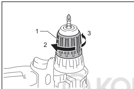
Поверните муфту против часовой стрелки для открытия кулаков зажимного патрона. Вставьте насадку для отвертки или головку сверла в зажимной патрон как можно глубже. Поверните муфту по часовой стрелке для затяжки патрона. Для снятия насадки/головки поверните муфту против часовой стрелки.
