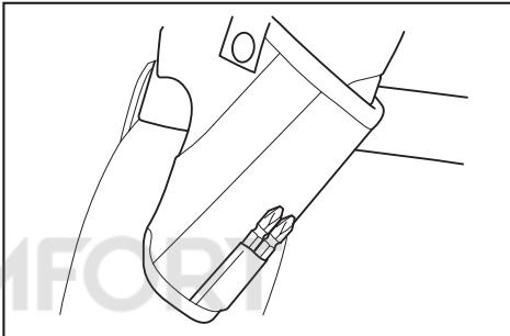
В передней части кобуры могут храниться две насадки для отвертки.
