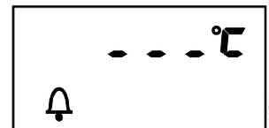
Символ колокольчик также означает сигналы, поступающие от контроллера к комнатному устройству через шину. Фактическая температурная величина остается на дисплее. В случае противоречия в адресе устройства, дисплей меняет установку.
