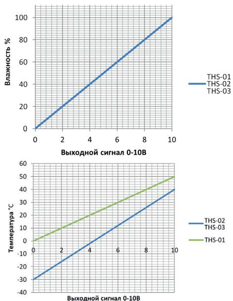
Для измерения параметров воздуха в преобразователях THS используются цифровые измерительные элементы с диапазоном измерения -40...+120 °C и 0...100% RH, которые преобразуются и передаются на выходные клеммы в виде 0-10В.
