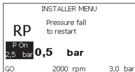
Рисунок 17: Настройка давления нового включения
