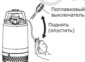
Рис. 10 Проверка направления вращения насоса с поплавковым выключателем
