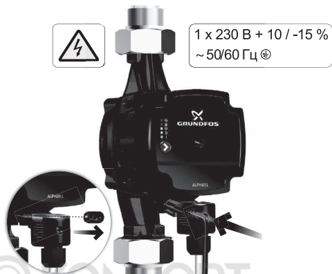
Рис. 9 Подключение сигнального кабеля к ALPHA1
