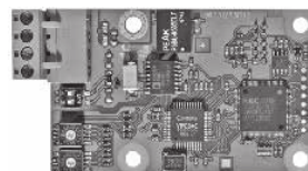
Նկար 139 Grundfos CIM տվյալների փոխանցման մոդուլ
