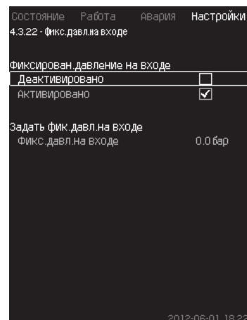
Рис. 98 Фикс. давл. на входе
