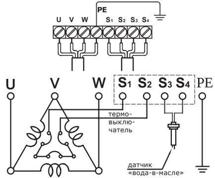
**Рис. 15** Схема подключения 3-фазного насоса, прямой пуск, схема соединения обмотки «треугольник». Электродвигатель с внешними выводами от термодатчика (клеммы S1, S2) и от датчика протечки (клеммы S3, S4)
