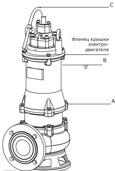
Рис. 11 Уровни включения, выключения, аварийного выключения (сухого хода)
