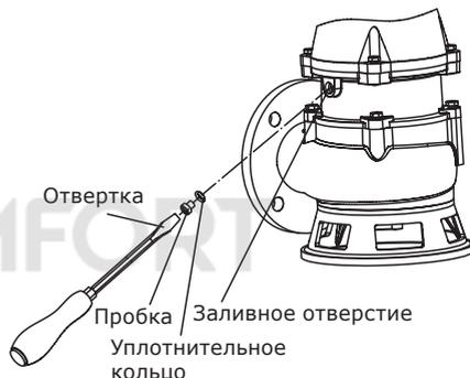
Рис. 18 Отверстие для слива и заливки масла
