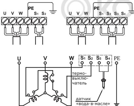
**Рис. 14** Схема подключения 3-фазного насоса, прямой пуск, схема соединения обмотки «звезда». Электродвигатель с внешними выводами от термодатчика (клеммы S1, S2) и с внешними выводами от датчика протечки (клеммы S3, S4)
