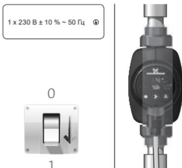
Рис. 11 Включение насоса
