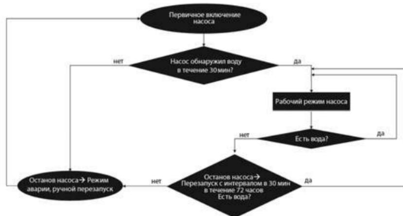
Рис. 25 Алгоритм работы защиты от «сухого» хода
