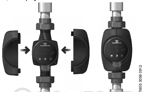
Рис. 8 Изоляция корпуса насоса
