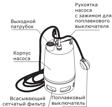
Рис. 1 Конструкция насосов APV.06 / APV.40 V
