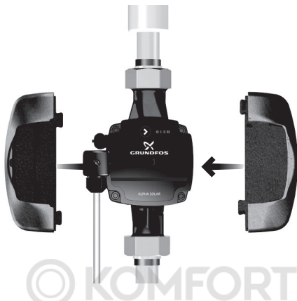
Рис. 8 Установка теплоизолирующего кожуха
