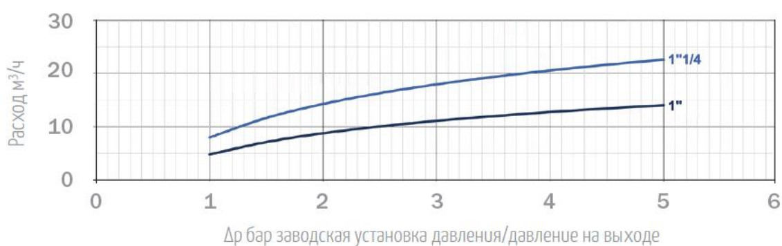
Диаграмма производительности редукторов давления Ду25, Ду32:
