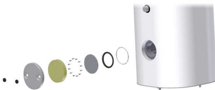
Рис. 11 Монтаж крышки смотрового отверстия (монтажная очередность)
