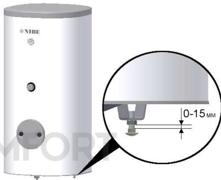
Рис. 4 Выравнивание устройства (W-E 750/1000.81/82 R)
