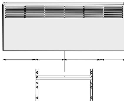
**4** Монтаж конвектора на крепление
