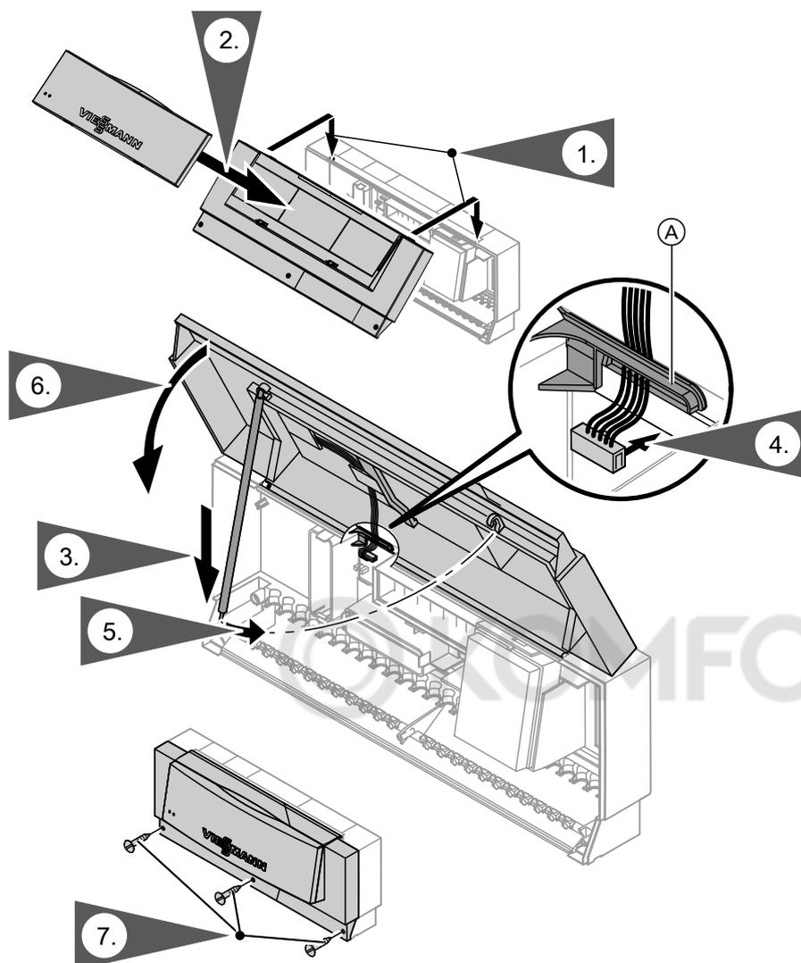
Рис. 21 Провести плоский кабель через крепление (А).
