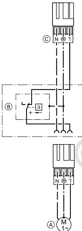
Электромеханическое термореле, работающее по принципу жидкостного расширения.
