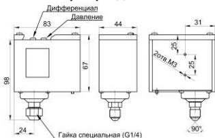
Рис.4 Габаритные и присоединительные размеры РД-2Р-0,8МПа-G1/2 (модель 35)
