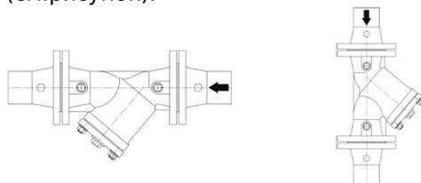
**ВНИМАНИЕ.** Монтаж фильтра необходимо осуществлять таким образом, чтобы направление стрелки на корпусе совпадало с направлением потока рабочей среды в трубопроводе.
