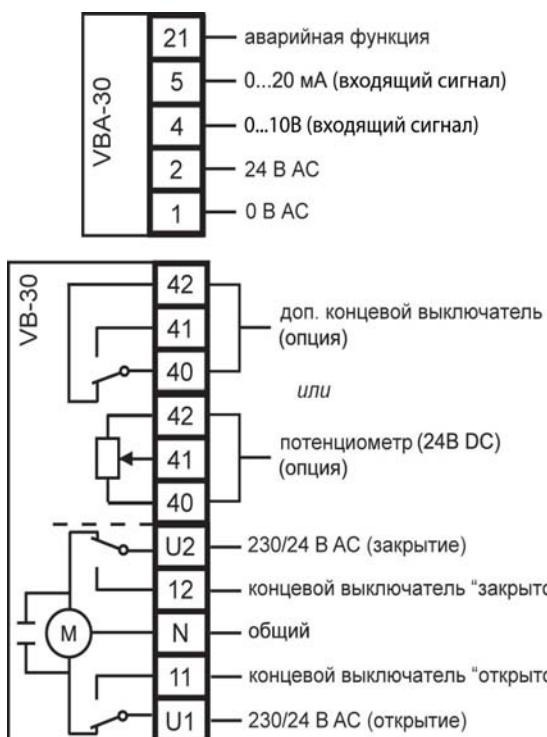
Снимите верхнюю крышку, открутив два винта. Соединение проводится через клеммный разъем согласно электрическим схемам. Кабель управляющего сигнала должен быть экранированным. Сечение проводов питания не менее 0,5 мм и не более 1 мм.
