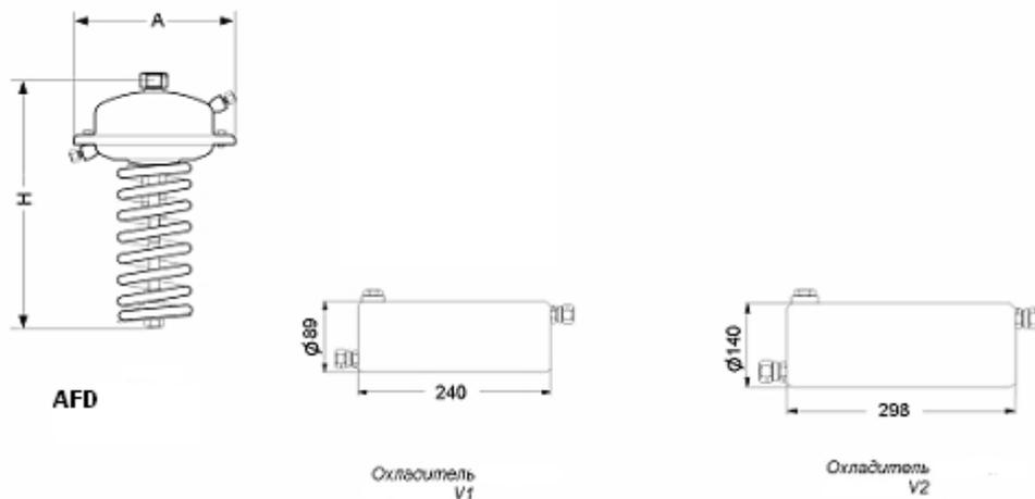
Рис. 4. Габаритные и присоединительные размеры блока регулирующего типа AFD
