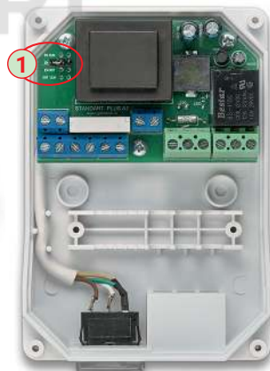
Фото 2. Блок управления GIDROLOCK STANDARD со снятой крышкой (1) – штыревой разъем, с помощью перемычки (джампера) которого можно изменять функционал блока управления
