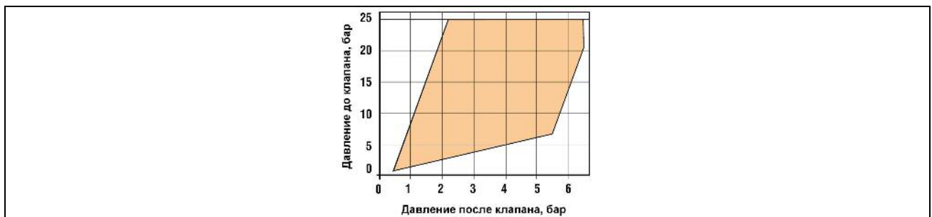
Рис. 2 Область применимости клапанов редукционных типа 11 bis в зависимости от давления до клапана и требуемого давления после клапана
