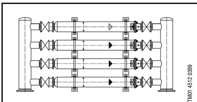
Установленный в напорном цилиндрическом корпусе погружной насос должен быть полностью окружен со всех сторон перекачиваемой жидкостью. Поэтому требуется защита от работы в сухую.
