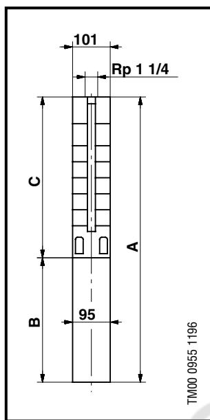
Максимальный диаметр насоса, включая защитную планку кабеля и электродвигатель, составляет 101 мм.
