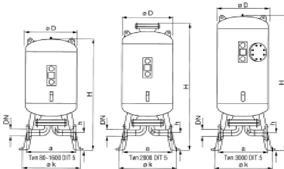
Со сменной мембраной из пищевой резины и фланцевым соединительным коленом в днище гидробака, поверхность колена покрыта полимерным материалом, прилагается свидетельство о прохождении заводских приемо-сдаточных испытаний, макс. эксплуатационная температура 70°C.
