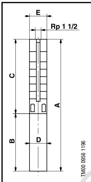
Насосы моделей SP 5A-75 и SP 5A-85 устанавливают в кожухе с присоединением R 1 $\frac{1}{2}$ .
