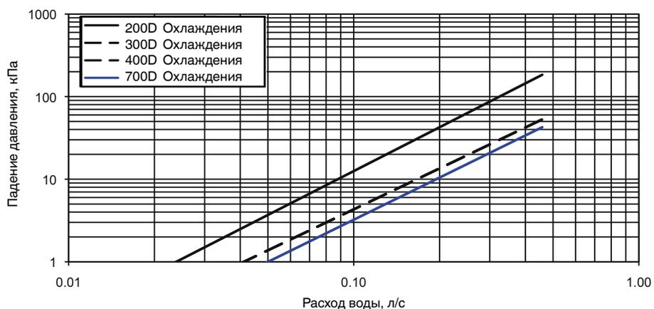
**В четырехтрубной системе, режимы обогрева**
