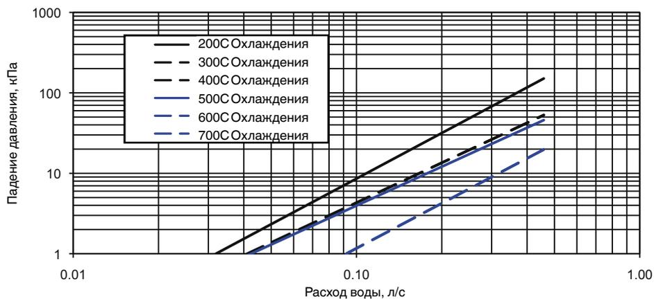
**В двухтрубной системе, режимы обогрева**
