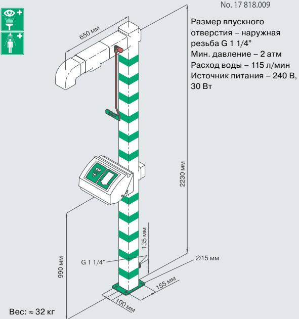
Подогреваемый душ для тела из гальванизированной стали с резервуаром душа для глаз, с ленточным обогревателем с предварительной изоляцией. Морозостойк – до -15 °С.
