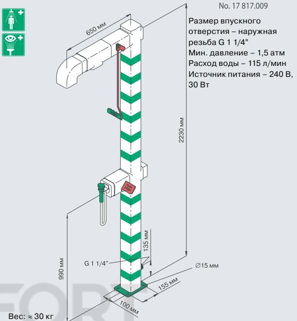
Подогреваемый душ для тела из гальванизированной стали с душем для глаз и гибким шлангом, с ленточным обогревателем с предварительной изоляцией. Морозостойк – до -15 °С.
