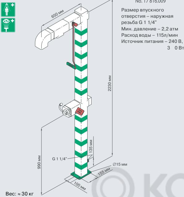
Подогреваемый душ для тела из гальванизированной стали с распылителем для глаз/лица, с ленточным обогревателем с предварительной изоляцией. Морозостойк – до -15 °С.
