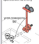
Душ для глаз из латуни с шарнирным соединением, позволяющим поднятие/опускание ствола с головками душа на 90°. С настольным креплением к задней части раковины, с химически стойким покрытием BROEN Polyoat. Расход воды регулируется встроенным компонентом FLOWFIX (26 л/мин).
