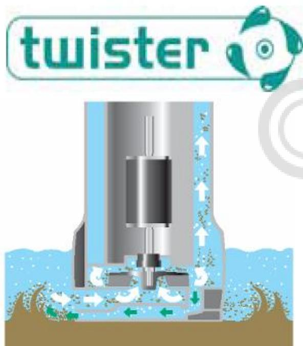
Исполнение TMW имеет взмучивающее устройство (TWISTER) для взмучивания оседающих взвешенных частиц. Благодаря этому в шахте практически нет запаха от перекачиваемой жидкости.
