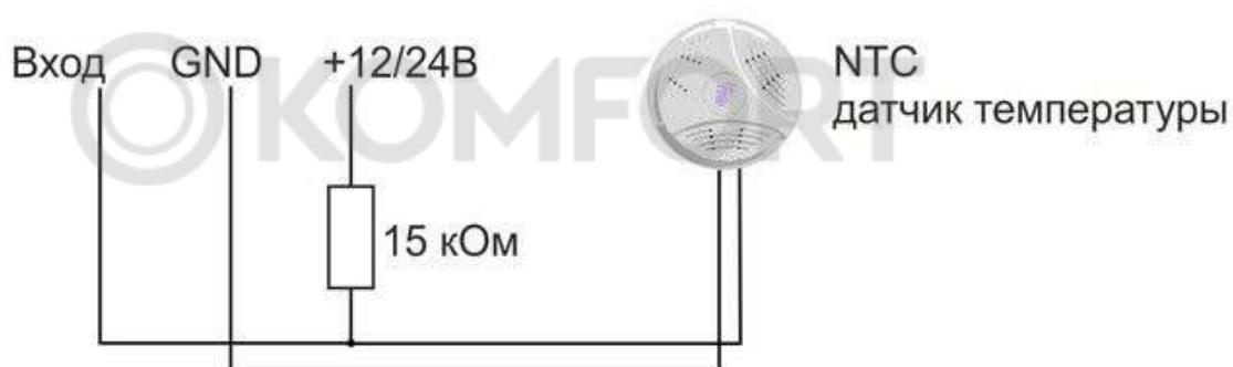
Подключение NTC датчиков температуры к регуляторам ZONT CLIMATIC:
