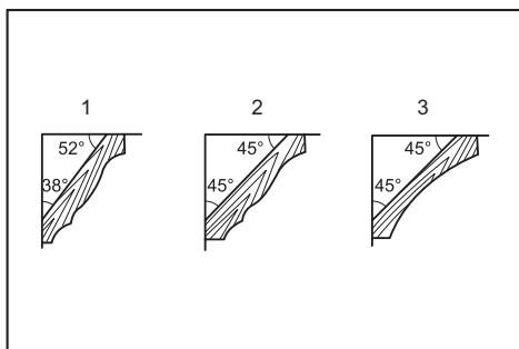
► 1. Поясок со стенным углом 52/38° 2. Поясок со стенным углом 45° 3. Погонаж со стенным углом 45°
