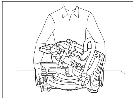
**ОСТОРОЖНО:** Стопорный штифт для подъема каретки предназначен исключительно для переноски и хранения, а не для распиливания. Использование стопорного штифта для распиливания может вызвать неожиданное перемещение пильного диска, что приведет к отдаче и тяжелым травмам.
