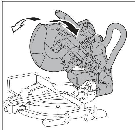
Если указатель не определяет значение 45°, переведите его в положение 45°, повернув регулировочный болт на другой стороне шкалы угла скоса.
