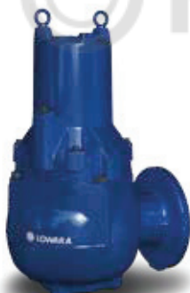
Lowara 1315 Vortex Макс. расход 44 л/с Макс. напор 15 м Мощ. двиг. 2,2 - 4,4 кВт Напорн. патрубок 65 - 100 мм Вес 95 кг
