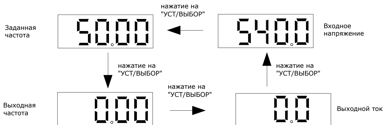
Рисунок 4.2-2 Переключение контролируемых параметров
