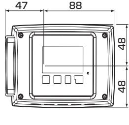
Установочные размеры для контроллера серии 90С со смесительными клапанами
