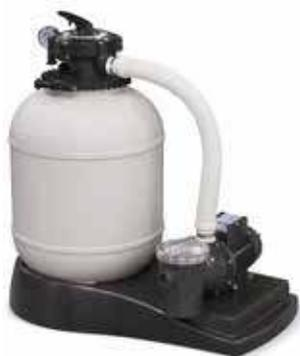
Фильтр моноблока изготовлен из пластика, оснащен быстростъемной крышкой, многопозиционным вентиляем и манометром. Включает ручной клапан сброса воздуха и воды. Моноблок укомплектован насосом.
