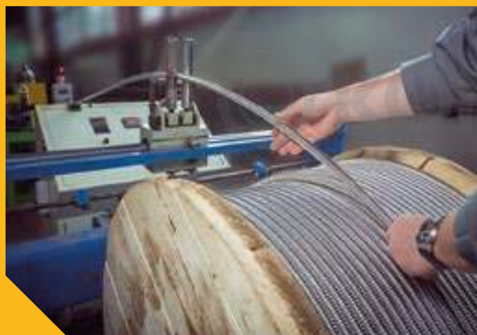
Подача гофрированной трубы Stahlmann для отжига
