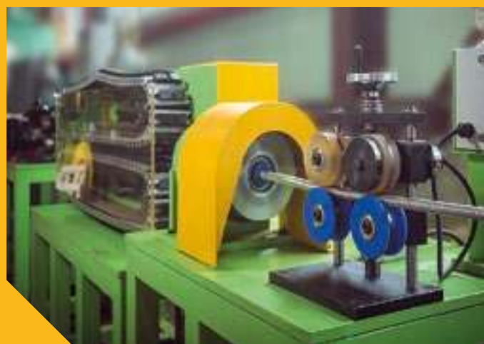
Процесс гофрирования трубы
