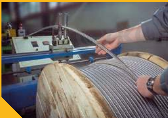
Подача гофрированной трубы Stahlmann для отжига
