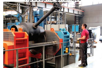
Тестирование шаровых кранов
