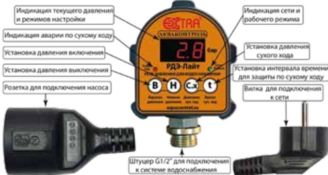
Электронное реле давления «EXTRA® Аваконтроль» РДЭ, РДЭ-К, РДЭ-ПП, РДЭ-Ст и БРД имеют расширенный набор функций управления и защиты насосом в системе бытового водоснабжения.
