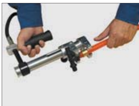
■ Выполнение соединения с помощью прессы.
