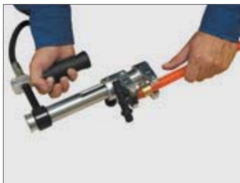
■ Выполнение соединения с помощью прессы.
