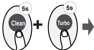
Одновременное нажатие Clean и Turbo более 5 секунд активирует блокировку. Повторное нажатие в течение 2 секунд разблокирует
