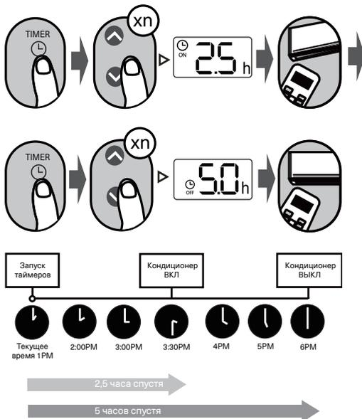
Пример: Если текущее время 13:00, то при установке таймера, как описано выше, устройство включится через 2,5 часа (15:30) и выключится в 18:00.
