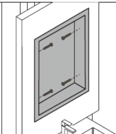
Закрепите шпильки с помощью крепежных винтов
