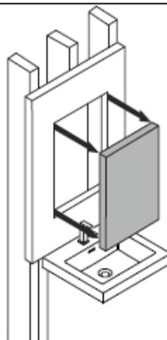
Вырежьте очерченный периметр при помощи подходящего инструмента
