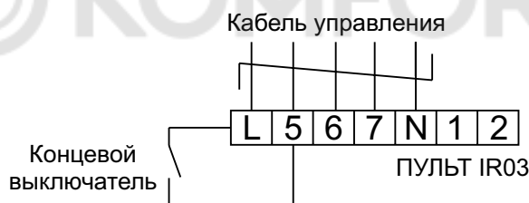
Рисунок 5. Схема подключения концевого выключателя к завесе
