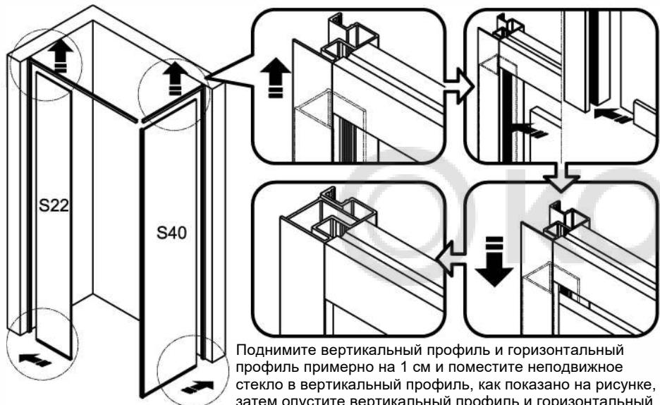
Поднимите вертикальный профиль и горизонтальный профиль примерно на 1 см и поместите неподвижное стекло в вертикальный профиль, как показано на рисунке, затем опустите вертикальный профиль и горизонтальный профиль и верните их назад.
