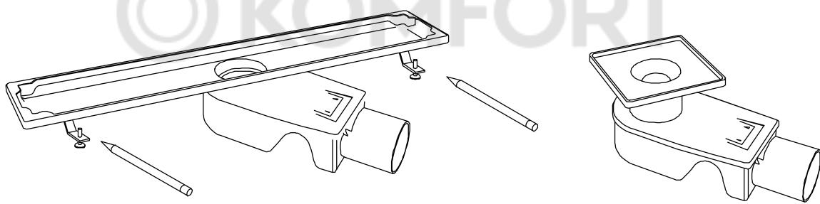
*После того, как ножки прикреплены к полу, их высота должна быть отрегулирована при помощи строительного уровня.*
