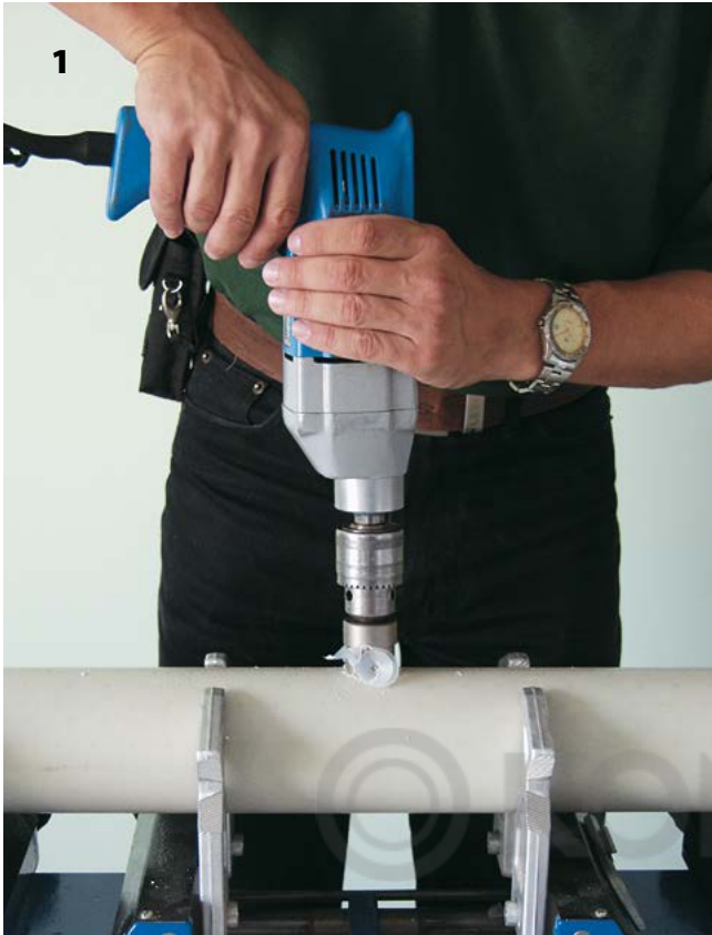
1 Специальной фрезой высверлить отверстие для седла
