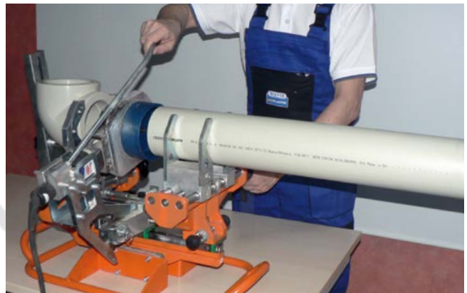
закрепление в аппарате и центровка, потом нагрев
