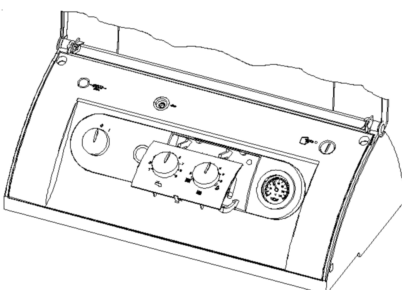
4. Inserire il pannello frontale con le clips. Successivamente inserire la manopola per acqua calda e quella per il riscaldamento con l'indice posizionato su "5". Dopodichè girare le manopole con cura fino all'arresto destro e sinistro. Se non è possibile girare la manopola sull'arresto destro e sinistro, la stessa manopola deve essere tolta e deve esser girata di 180°.
