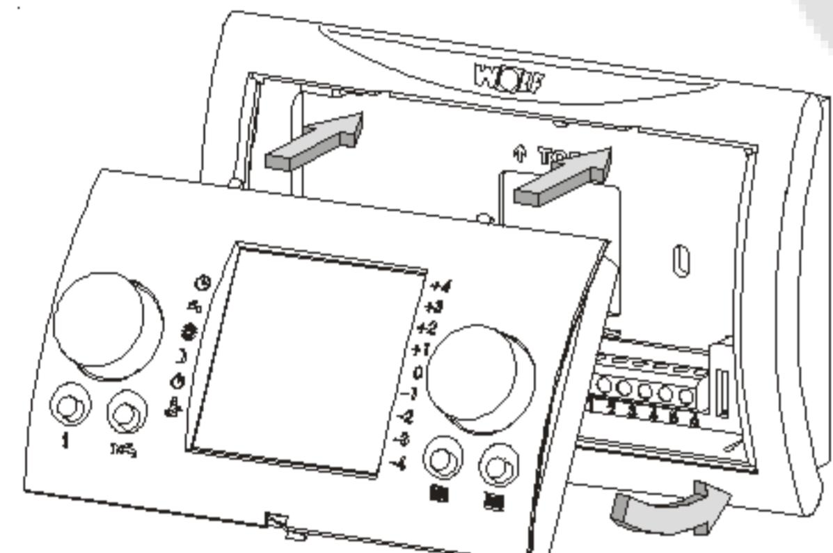
3. Clipser le module de commande BM dans le socle mural.
