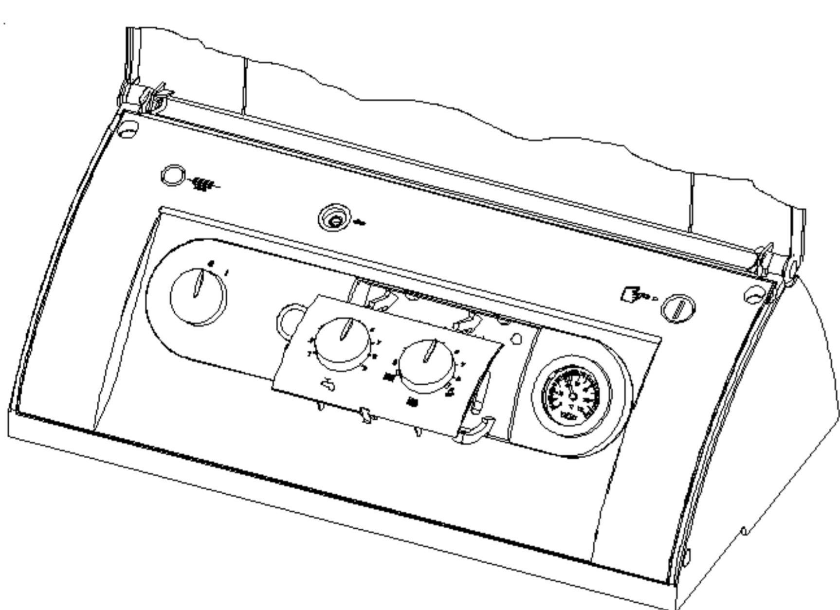
4. Clipser le plastron. Ensuite, enfoncer le commutateur rotatif pour l'eau chaude et celui pour le chauffage avec l'aiguille sur « 5 ». Finalement, tourner avec précaution les commutateurs rotatifs jusqu'en butée à gauche et à droite. Si il est impossible de tourner le commutateur rotatif jusqu'en butée à droite ou à gauche, sortir ce dernier et le tourner de 180°.
