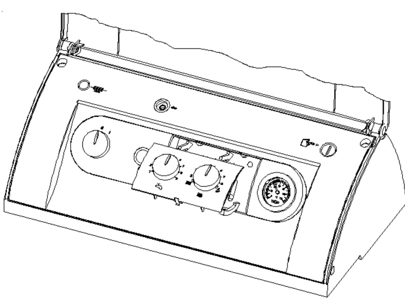
4. Frontblende einclipsen. Danach den Drehknopf für Warmwasser und den Drehknopf für Heizung mit Zeiger auf 0 einstecken. Anschließend die Drehknöpfe vorsichtig auf Links und Rechtsanschlag drehen. Lässt sich der Drehknopf nicht auf Rechts und Linksanschlag drehen, muss der Drehknopf abgezogen und um 180° gedreht werden.
