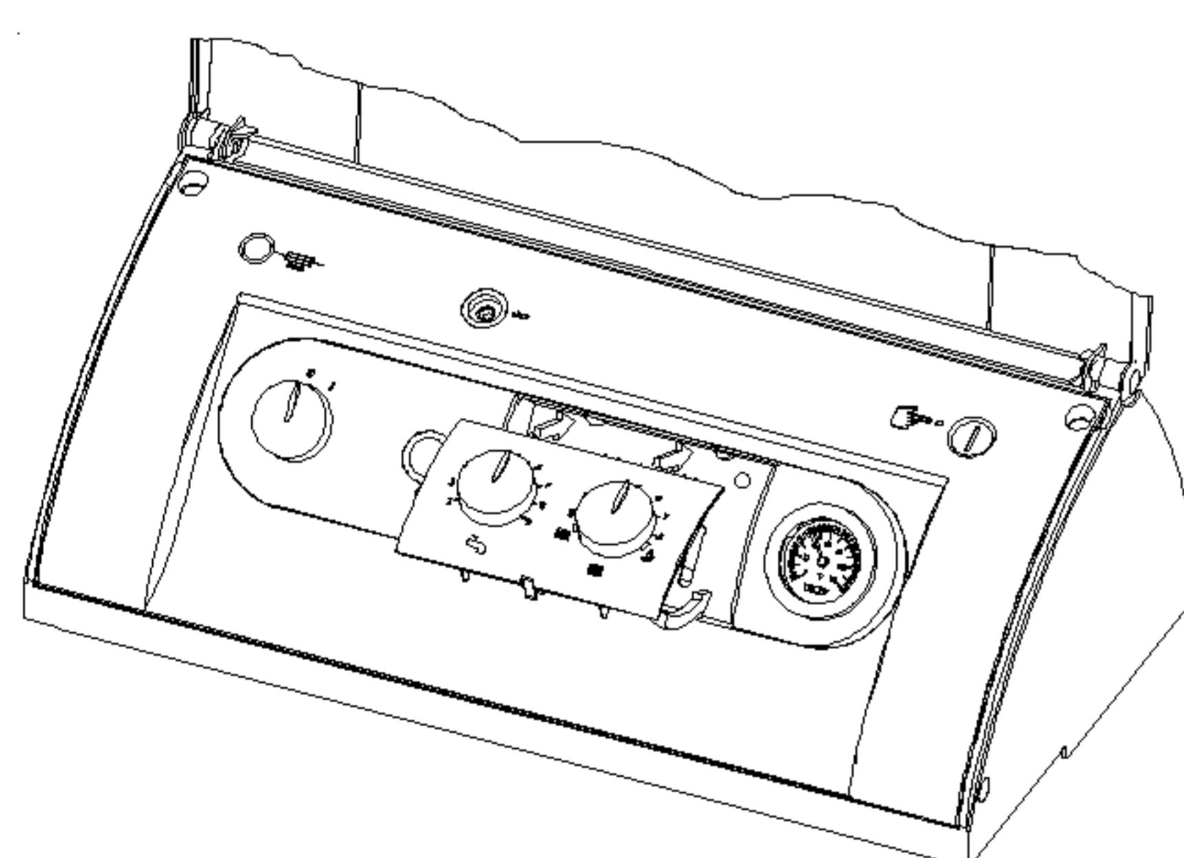
3. Klik de bedieningsmodule BM in de wandsokkel.
