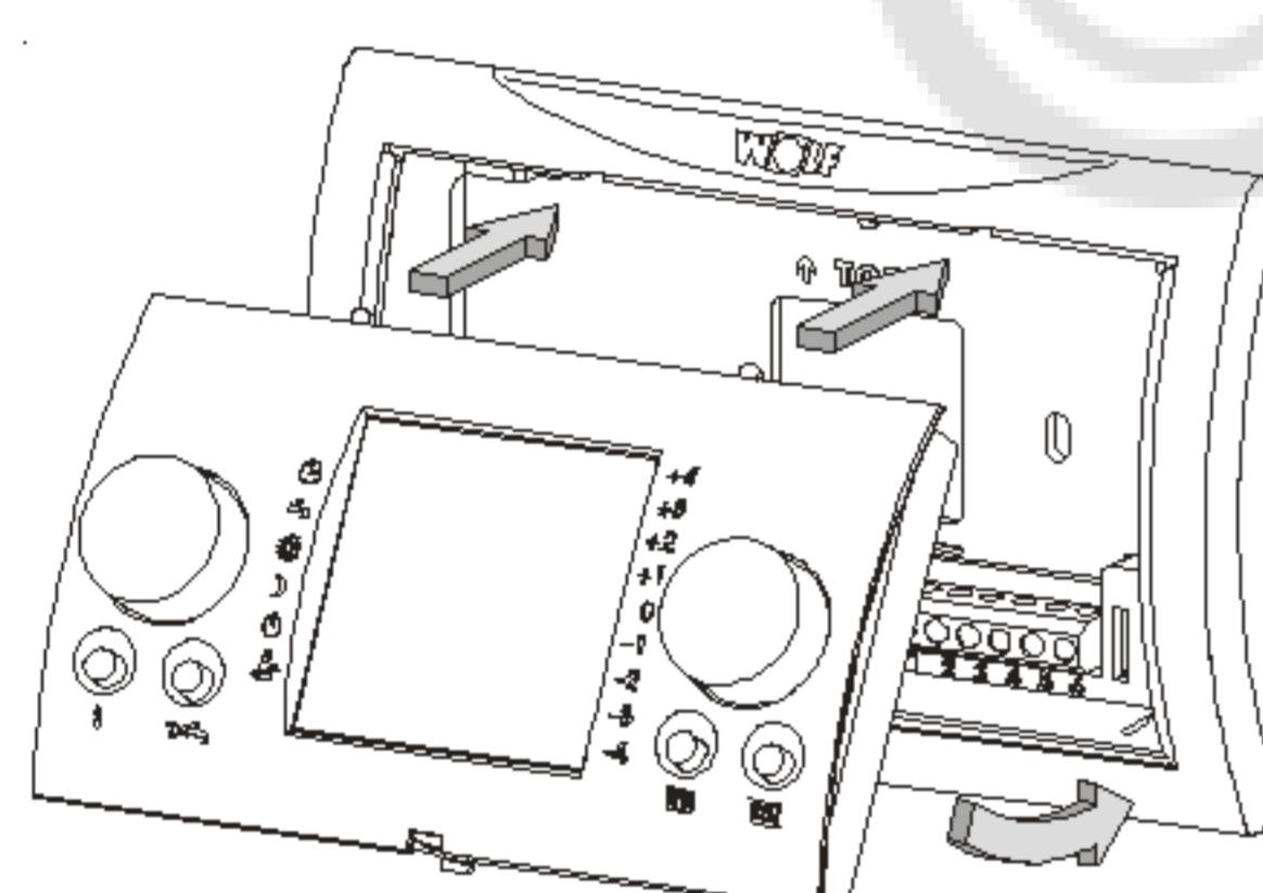
2. Verwijder de bedieningsmodule BM uit de ketelregeling.
