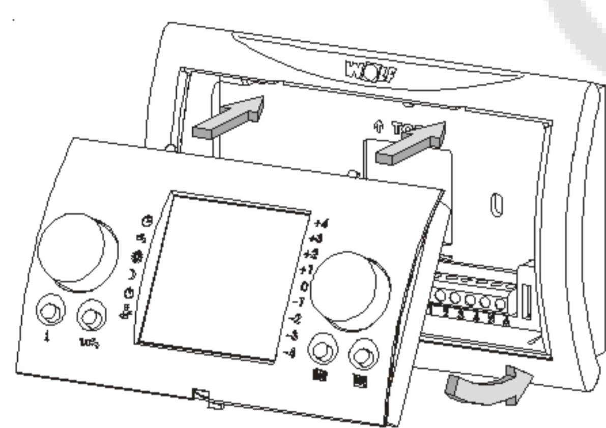
3. Bedienmodul BM in den Wandsockel einclipsen.
