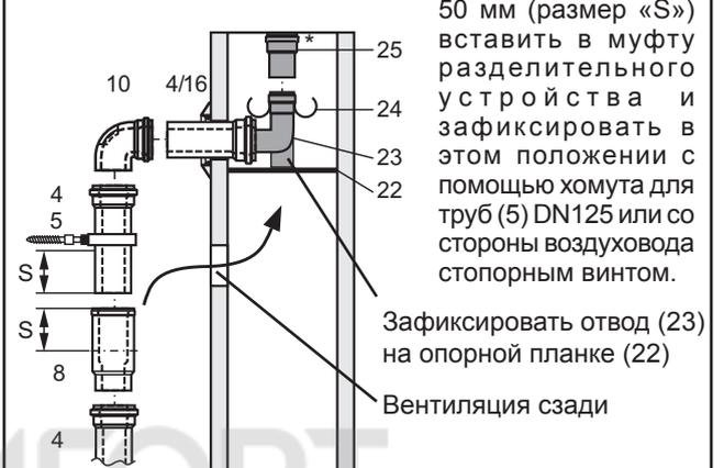
вставить в муфту разделительного устройства и зафиксировать в этом положении с помощью хомута для труб (5) DN125 или со стороны воздуховода стопорным винтом.
