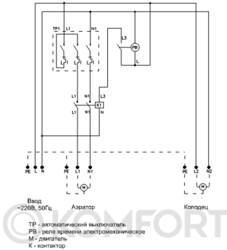
Рис. 5. Принципиальная схема щита управления ЛОС 5М
