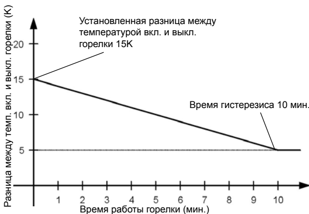
Рис.: Временная зависимость гистерезиса переключения горелки при разнице между температурой включения и выключения горелки, определенной пользователем как 15К, и выбранного времени гистерезиса 10 мин. (параметр HG33)
